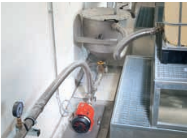
F 550 TR in azione nel settore industriale – pompaggio di ammorbidente viscoso.
